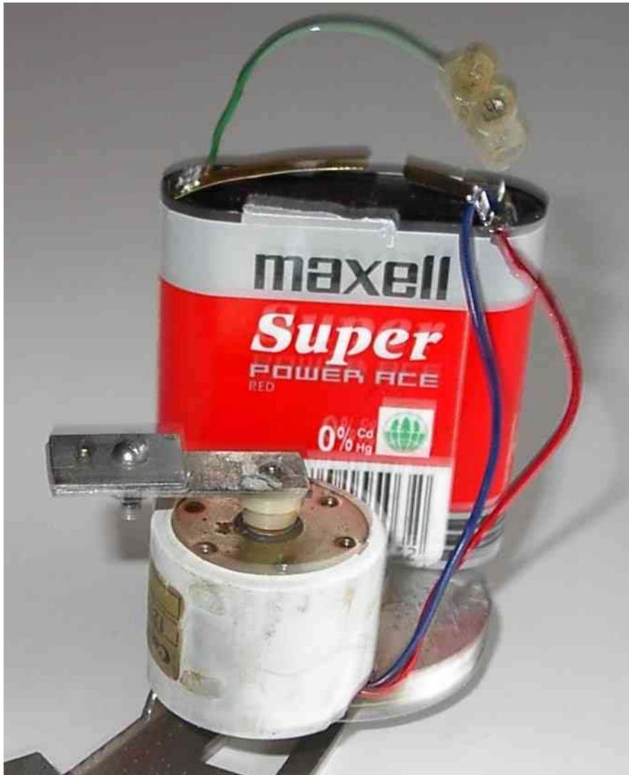
EL GIRO DEL CONJUNTO ALCANZA VELOCIDAD CONSTANTE, QUE PUEDE SER MAYOR O MENOR SEGÚN LA VELOCIDAD DE L MOTOR Y SE ESTABILIZA RÁPIDAMENTE CUANDO SE INTENTA VARIAR EXTERNAMENTE
